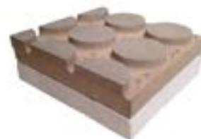
Pannello in polistirene espanso densità 15÷35 kg/m<sup>3</sup> | Conduttività termica dichiarata  $\lambda_b$ [W/(m\*k)] 0,026÷0,036 | Calore specifico c 1.200 J/kg K
