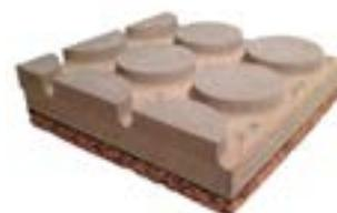
Pannello in sughero biondo densità 150÷160 kg/m<sup>3</sup> | Conduttività termica dichiarata  $\lambda_D$  [W/(m\*k)] 0,041 | Calore specifico c 1.674 J/kg K
